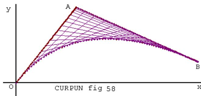
La curva OB indicata in figura 58 sappiamo essere una curva ricavata da due segmenti OA e AB, ma sappiamo anche (come d'altronde abbiamo visto in 3\*\*) che i due segmenti in questione OA e AB possono a loro volta diventare delle curve, al variare di ( $t_1$ ) e ( $t_2$ ).
