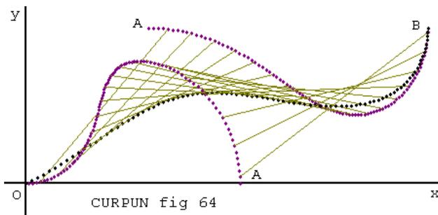
Nella figura 64 i segmenti sono stati variati per ( $t_1$ )=2 e ( $t_2$ )=2 dando come risultato la curva OB, inoltre sono state tracciate le congiungenti tra OA e AB, che vengono a formare la curva risultato OB.
