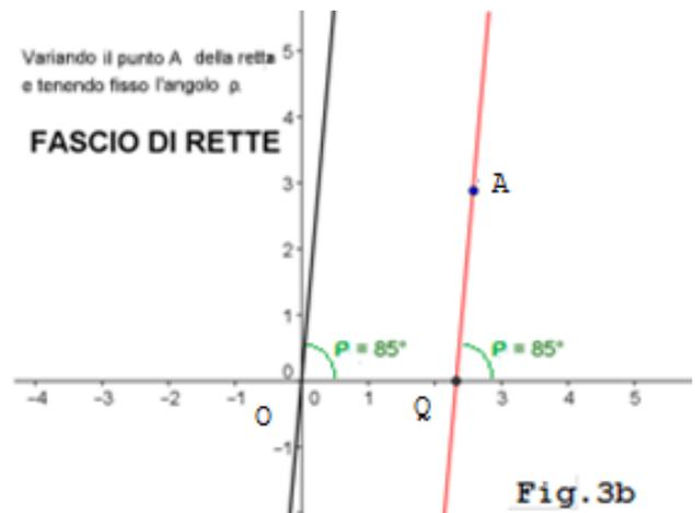
lasciando fisso A e variando l'angolo  $\rho$  come in Fig.3a abbiamo le infinite rette che ruotano intorno al punto A, cioè una Stella di Rette. Invece per un angolo  $\rho$  fisso, Fig.3b, e incrementando il valore dell'ascissa (con ordinata fissa) del punto A abbiamo un insieme di rette parallele, cioè un Fascio di Rette.
