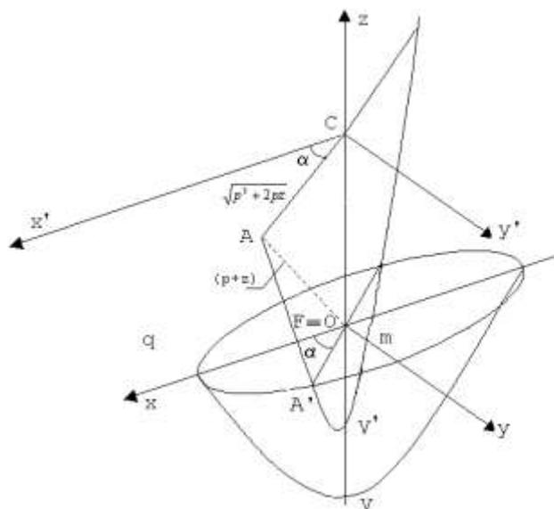
Dalle espressioni viste sul piano possiamo trarre da una delle parabole (Es.:quella del tipo  $(p+z)$ ) come luogo geometrico della distanza tra il Fuoco (Origine) e punto delle parabole aventi come asse di simmetria l'asse  $z$ . Scriviamone l'Eq. di Vag:
