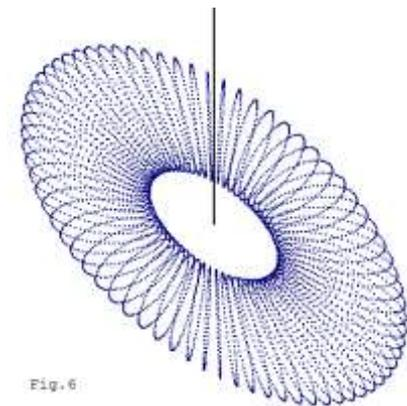
Se spostiamo il centro della ellisse nel punto C(C<sub>x</sub>, 0) la figura ruoterà per intero intorno all'asse z: avremo così ottenuto la figura che è chiamata "toro", come in Fig.6 (in assonometria).
