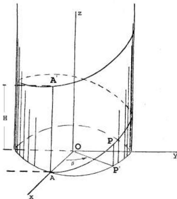
Dato un cilindro o un cono, un punto che si muova sulla sua superficie con movimento rotatorio e traslatorio lungo l'asse z (cioè che la sua traiettoria ne incontri le generatrici sotto un angolo costante) forma una Elica.
