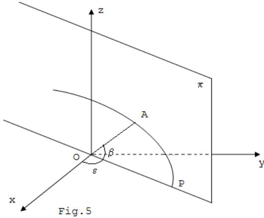
In un piano π perpendicolare a xOy sia una ellisse come da Fig.5 e un suo punto di valore A(x<sub>E</sub>, y<sub>E</sub>) e come punto nello spazio i valori A(x, y, z; α<sub>1</sub>, α<sub>2</sub>, α<sub>3</sub>) e l'angolo xÔP = ε.
